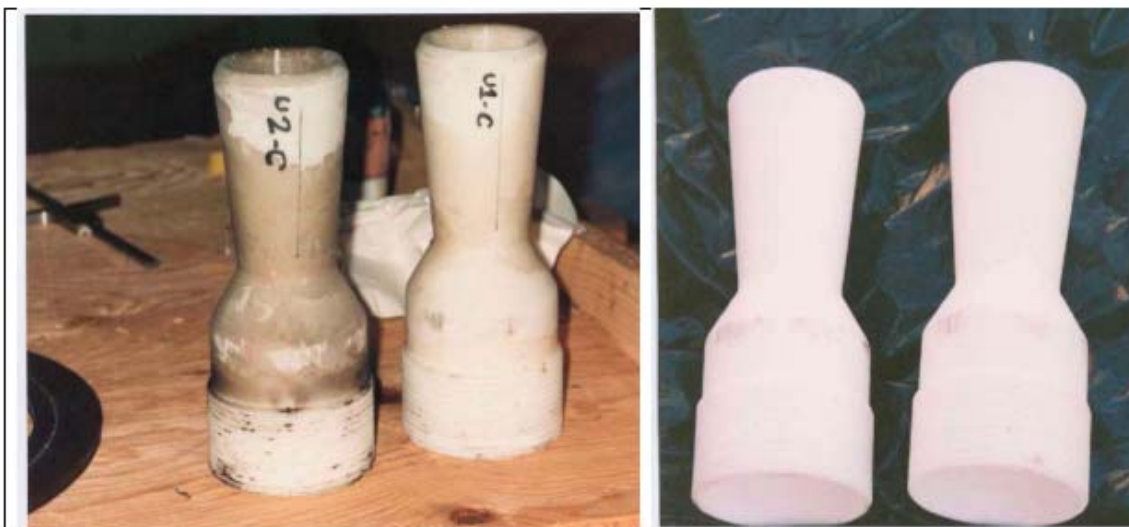
Slika 3. Stanje mlaznice pri nekontrolisanog isklopu ( lijevo) I kontrolisanom uklopu ( desno)
