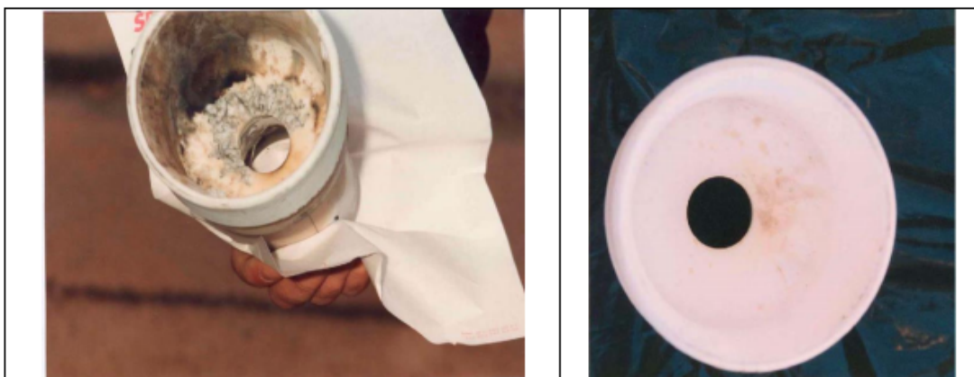
Slika 4. Stanje mlaznice pri nekontrolisanog isklopu ( lijevo) I kontrolisanom uklopu ( desno)
